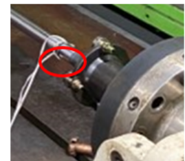
Strain gauge 부착 영역
